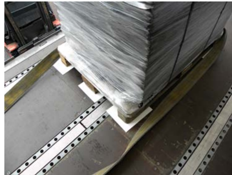
Bild 1: Anordnung der RhM Pads unter den Kufen – Zug längs zu den Kufen
